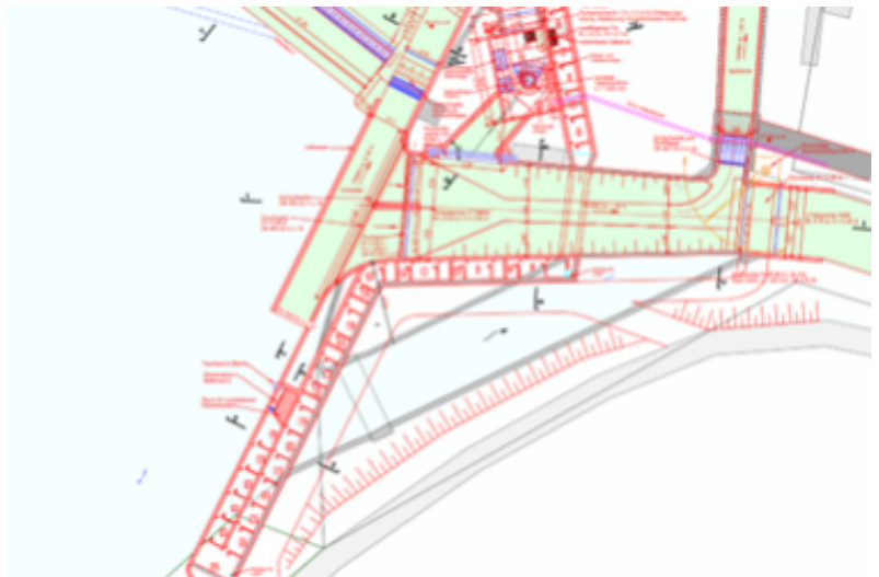
Neu geplante lachsgängige Fischaufstiegshilfe am Wehr des KW Papieri mit Leitströmturbine
