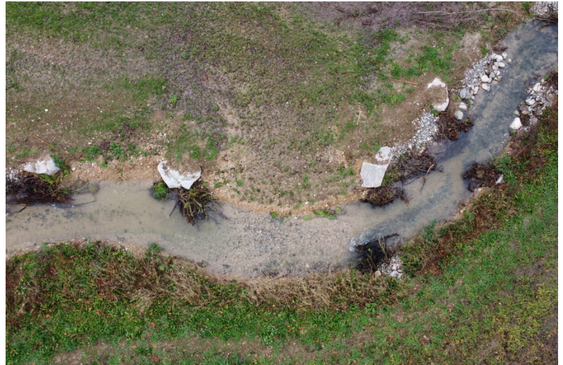
Neues Gerinne (2.5 m x 0.7 m) mit Kiesrausche und Totholzstrukturen (Fließrichtung von links nach rechts)
