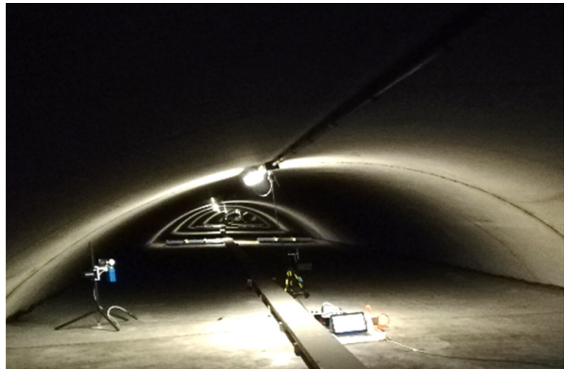
Vertiefte Prüfungen (z.B. Leckagemessungen im Abluftkanal)
