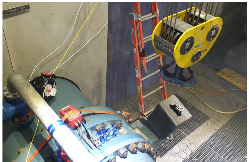
Erschütterungsmessgerät montiert auf der Drosselklappe Maschinengruppe 1
