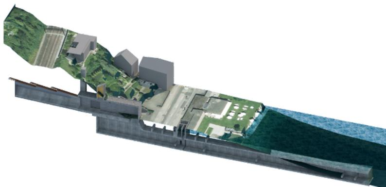
Visualizzazione BIM della struttura di scarico
