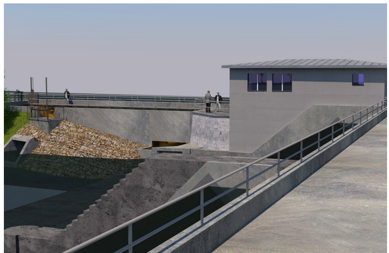
Visualisierung Mäanderfischpass, Blick von der Wehrbrücke
